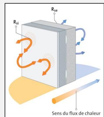
Le coefficient d'échange thermique superficiel entre une ambiance intérieure ( $h_i$ ) et une paroi est la somme des quantités de chaleur transmise entre une ambiance intérieure et la face intérieure d'une paroi, par convection et par rayonnement, par unité de temps, par unité de surface de la paroi, et pour un écart de 1 K entre la température de la résultante sèche de l'ambiance et la température de surface.
