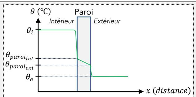
La température intérieure chute brutalement lorsqu'on arrive vers la surface intérieure de la paroi, elle continue de diminuer légèrement de façon linéaire dans la paroi, puis chute brutalement au niveau de la surface extérieure.
